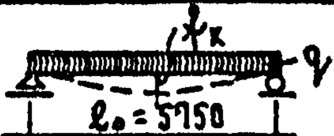
СХЕМА ОПИРАНИЯ И ЗАГРУЖЕНИЯ ПРИ ИСПЫТАНИИ (ПЛОЩАДЬ ЗАГРУЖ. 5.75x1.56 м)
