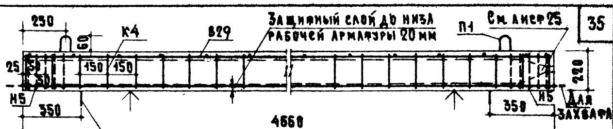
Места опирания при складировании и транспортировке РАЗРЕЗ 1-1
